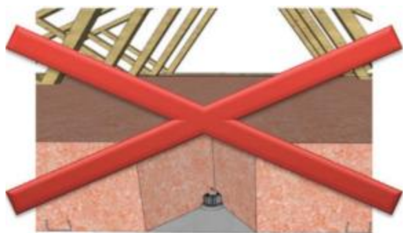
Figure 1 – Spot non protégé au contact de l'isolant INTERDIT
